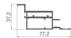
D-A632/ 主框 T: 1.4mm G: 1.102kg/m
