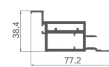
D-A633/ 主框 T: 3.0mm G: 1.443kg/m
